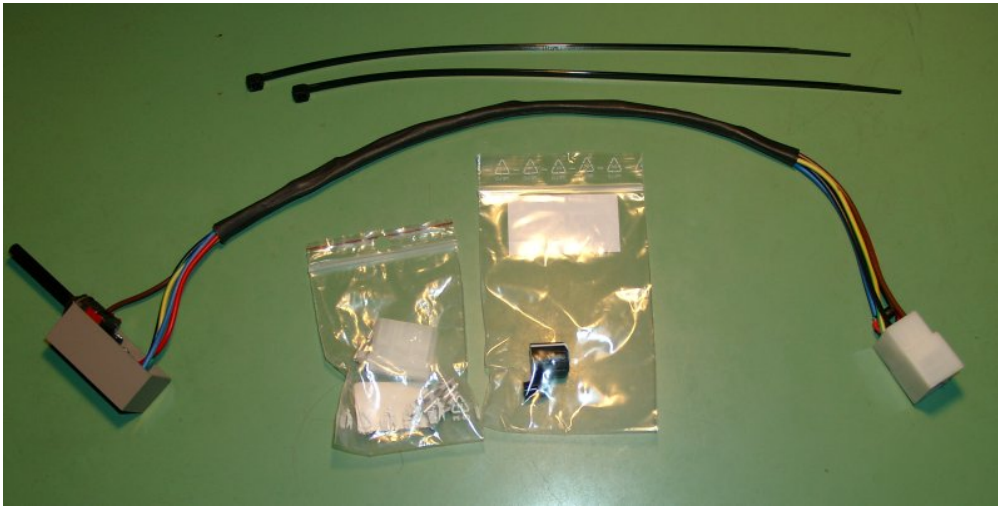
Abbildung 11: Ein einbaufertiger Satz: Neben dem Intervall gehört ein Drehknopf, ein Weibchen passend zum Stecker der Baugruppe zum selbercrimpen und zwei Kabelbinder dazu. Einen zum Verlegen des Kabels und einen um den Stecker zu sichern.
